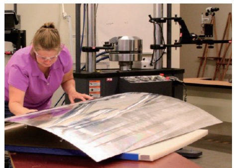
(b) 带筋壁板成形效果
